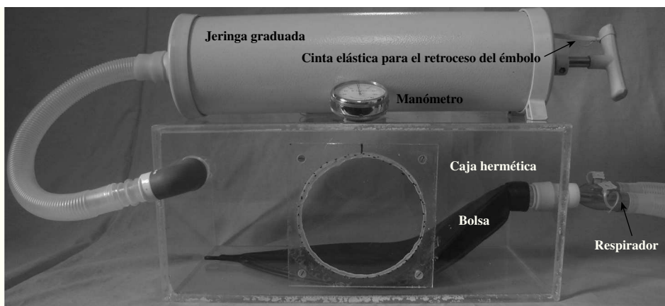
Fig. 1. Sistema de bag-in-box como simulador pulmonar. La bolsa, de 2 l, se conecta al ventilador, y la caja, de 8 l, a una jeringa de calibración de 3 l con retroceso elástico del émbolo.
