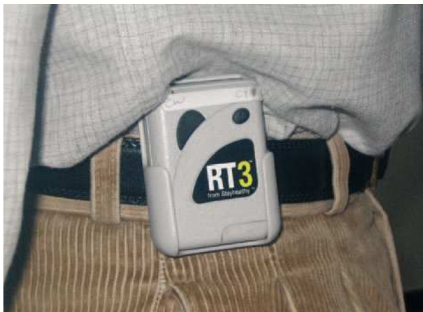
Fig. 1. Colocación del acelerómetro RT3 durante la realización de un registro.
